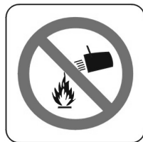
SP-020 PROHIBIDO APAGAR CON AGUA
