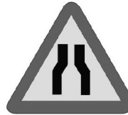
TP-17 ESTRECHAMIENTO DE CALZADA
