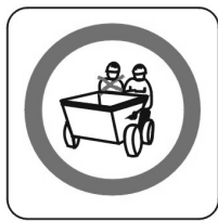
SP-240 PROHIBIDO TRANSPORTAR PERSONAS
