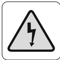
SA-060 RIESGO ELÉCTRICO
