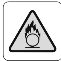
SA-020 ¡PELIGRO! MATERIAL COMBURENTE
