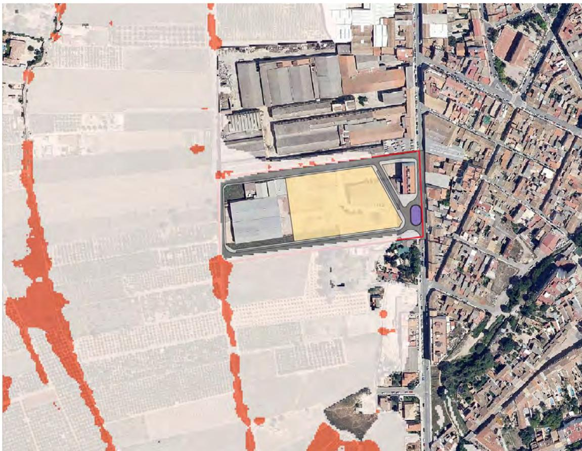
Fig.- 23 Detalle velocidad Z.I. con probabilidad baja ( $T= 500$  años) obtenida por HEC-RAS (Situación Modificada)
