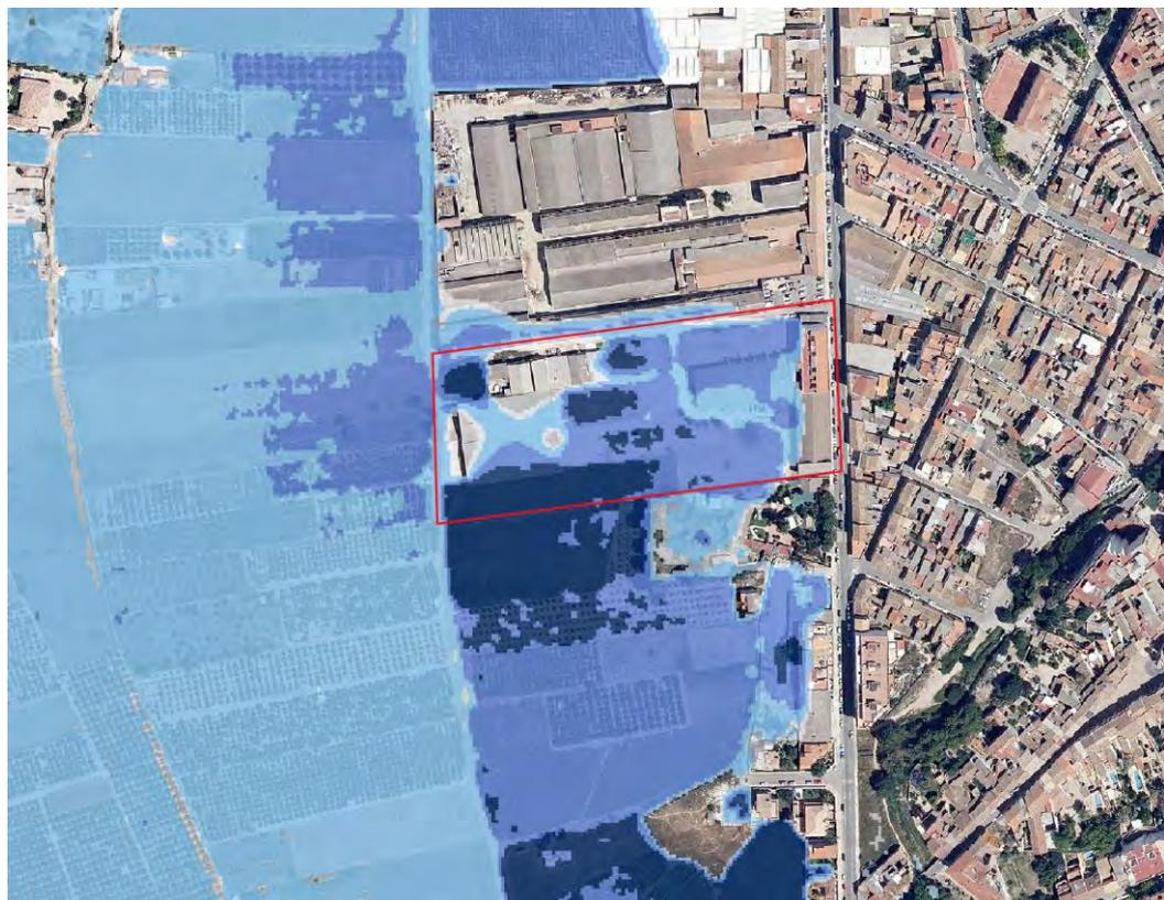
Fig.- 20 Detalle calados Z.I. con probabilidad baja (T= 500 años) obtenida por HEC-RAS
