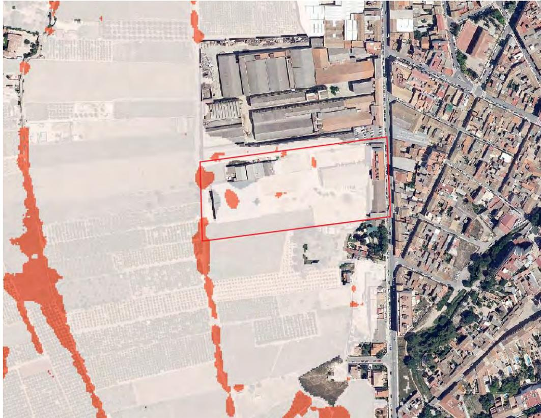
Fig.- 21 Detalle velocidad Z.I. con probabilidad baja ( $T= 500$  años) obtenida por HEC-RAS
